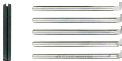
Резьбовой - метрический 60°, дюймовый 55°. По одному расточному резцу 1,3 – 2,65 – 4 мм. Диаметр 6 мм. Длина 95 мм. Резцы вставляются в прилагаемый адаптер и зажимаются в резцедержатель станка PD 230/E, PD 250/E или PD 400. Упакованы в деревянную коробку с выдвигающей крышкой.
