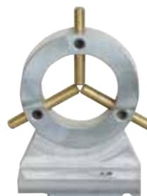
Удобна при расточке. Также используется, если невозможно задействовать заднюю бабку. До Ø 40 мм.
