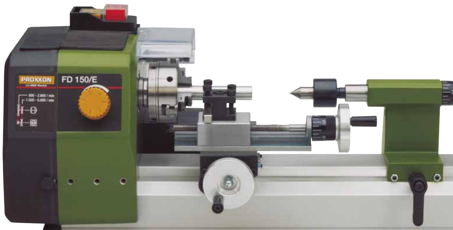
**Межосевое расстояние 150 мм. Высота центров над направляющими 55 мм. Высота над суппортом 33 мм.**
