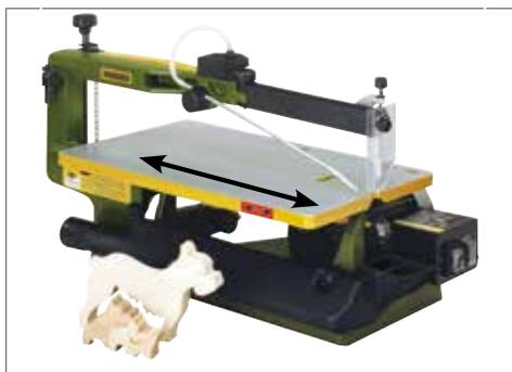
**Запатентованная технология:** для удобства замены пилки стол в горизонтальном положении можно сдвинуть на 80 мм. Это облегчает обзор и установку нижнего зажима или штифтовой пилки.
