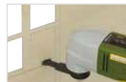
Угловая шлифовка OZI/E работает нормально там, где другим инструментом работать невозможно (диск из быстрорежущей стали).
