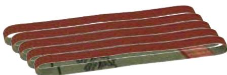
Корунд на жесткой, тканой основе. Для шлифования металлов, цветных металлов, дерева и пластиков. 330 x 10 мм.
