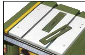
Планка из ABS для более высокой точности при резке мелких деталей (прорезается снизу диском FET).
