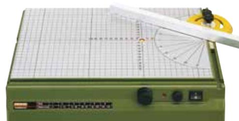
Поворотная направляющая со шкалой и фиксатором. (Немецкий патент 100 00 102.5)
