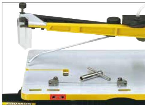
Обычные пилки с плоскими концами надежно крепятся с помощью двух патентованных зажимов. Такое крепление обеспечивает правильное положение пилки. Прорезь в столе служит шаблоном для установки пилки в зажимах.
