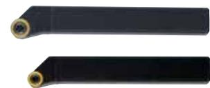
держатель имеет угол влево на 45° для установки цилиндрических вставок из карбида вольфрама Ø 6 мм. Особо высокое качество поверхности и низкая шероховатость. Для точения радиусов и нарезания круглых канавок. В комплект входят две вставки из карбида вольфрама, два крепежных винта, и ключ TX 8.
