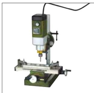
На сверлильной станине MB 200 и координатном столе KT 70.
