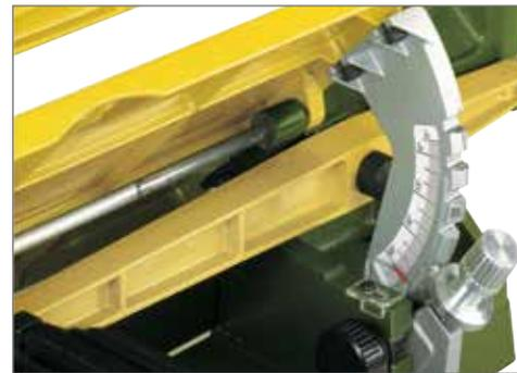
**Угол наклона стола регулируется от -5° до 50°.** Большие углубления на шкале на 0°, 10°, 20°, 30° и 45° для грубой настройки. Дополнительная тонкая настройка для усовых соединений осуществляется с помощью маховика.
