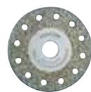
**Отрезной и обдирочный диск с алмазным напылением** Для резки, обдирки и шлифования твердых материалов, таких, как стекло, фарфор, керамика и камень. Вентиляционные отверстия предупреждают нагрев. Ø 50 x 1 мм, посадочное отверстие 10 мм.
