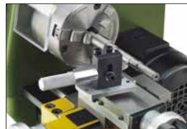
**Приспособление для крепления бормашины на токарном станке**
