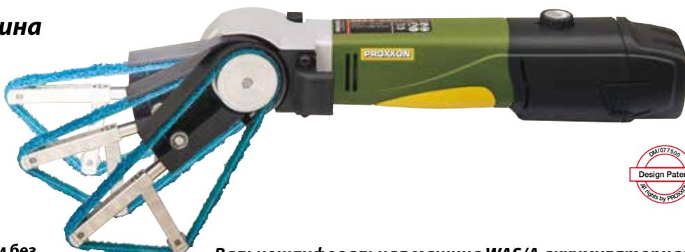
Для превосходной обработки поверхности без последующей ручной доработки. Идеально подходит для обработки поручней из нержавеющей стали и трубопроводов. Шлифовальный кронштейн путем нажатия кнопки можно отклонять на угол до 60°. Всасывающий патрубок с адаптером для пылесоса позволяет работать в чистоте. Вкл. 4 шлифовальные ленты (2x K 80 и 2x K 180) и 2 полировальные ленты. В комплект поставки входит литий-ионный аккумулятор (10,8 В) и быстрое зарядное устройство LG/A2.
