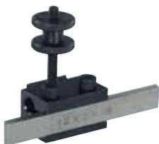
Используется в системе быстрой смены резцов PD 250/E. Для отрезания и вырезания пазов. Резец 12 x 3 x 85 мм из быстрорежущей стали с добавлением кобальта.
