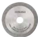
Диаметр 50мм, посадочное отверстие 10мм. Слой 0,5мм алмазного напыления класса «D 107». Для резания керамики, фарфора, камня, а также листового стеклопластика
