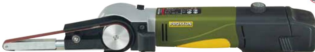
Для шлифования небольших отверстий, окончательной обработки пресс-форм, поверхностей, радиусов, канавок, заусенцев и фасок точных деталей. Шлифовальный кронштейн путем нажатия кнопки можно отклонять на угол до 60°. Всасывающий патрубок с адаптером для пылесоса позволяет работать в чистоте. Вкл. 4 шлифовальные ленты (по 2 шт. зернистости К 80 и К 180). В комплект поставки входит литий-ионный аккумулятор (10,8 В) и быстрое зарядное устройство LG/A2.
