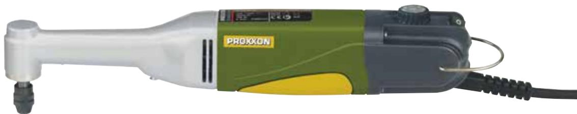
**Идеально подходит для сверления, фрезерования и т.п. в труднодоступных местах, например, корпуса моделей.** Сбалансированный двигатель с максимальной мощностью 100 Вт и электронной регулировкой во всем диапазоне скоростей. Корпус из усиленного стекловолокном ПОЛИАМИДА. Головка из литого под давлением алюминия. Упакована в прочный пластиковый чемодан.
