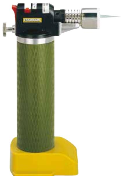
**Используется для пайки твердым и мягким припоем, разогрева и поджига, лужения и т.п.** Регулировка пламени изменением соотношения смеси газ-воздух позволяет получить тонкое пламя с температурой до 1200 °С. Пьезоэлемент.
