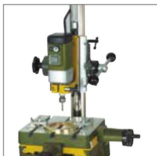
На сверлильно-фрезерной станине BFB 2000 и координатном столе KT 150.
