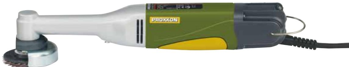
Для обработки стали, цветных металлов, стекла, керамики, древесины и пластиков. Предназначена для резки, обдирки, шлифовки, полировки, финишной обработки и резьбы по дереву. Сбалансированный двигатель. Головка из литого под давлением алюминия. Корпус из усиленного стекловолокном ПОЛИАМИДА. В комплект входят шлифовальный диск (карборунд К60), ламельная шлифовка (K100) и отрезной диск. Упакована в прочный пластиковый
