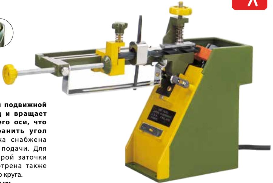
Процесс заточки полностью контролируется подвижной кареткой, которая движется вперед-назад и вращает сверло вокруг его оси, что позволяет сохранить угол заточки. Каретка снабжена винтом плавной подачи. Для обеспечения острой заточки сверла предусмотрена также правка абразивного круга.
